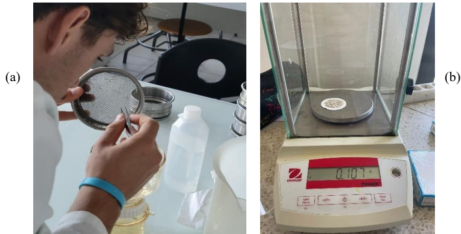
Figure 9. Photographies du dépôt des classes de zooplancton >1000 \mu\text{m} sur les filtres GF/C à l'aide d'une pince Brucelles (a) et de la pesée de la biomasse dessiquée (pesée du filtre GF/C après passage à l'étuve sur une balance de précision au milligramme) (b).
