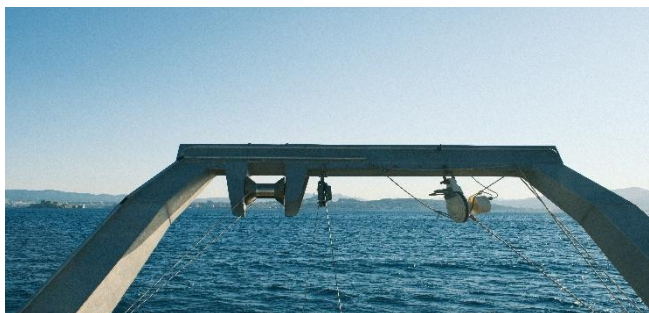
Figure 3. Photographie du treuil de l'Antédon II permettant le déploiement de capteurs océanographiques.
