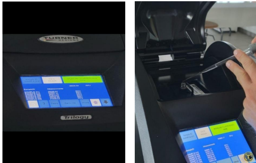
Figure 6. Photographies des mesures de chlorophylle a par fluorimétrie avant et après ajout d'acide chlorhydrique à 0,1 M
